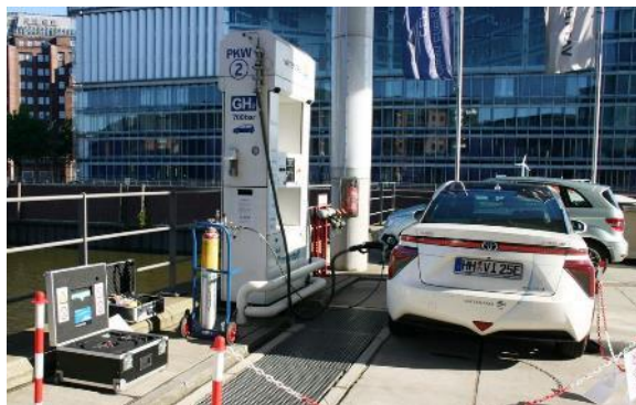
Muestreo de hidrógeno de una estación.
